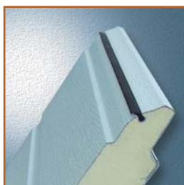
Panel o síle 45 mm ( U=0,61 \text{ W/m}^2\text{K} )
