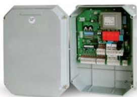
ELPRO S40 elektronická řídící jednotka pro 1-4 výsuvné sloupy
