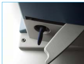
odblokování pohonu ROAD 400 pomocí klíčku a odblokovací páky
